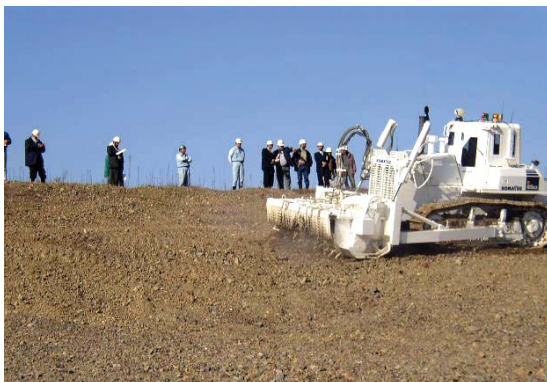
既存の建機をベースに開発された地雷除去機
