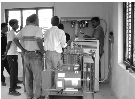
地方都市ボカラの国際家畜飼育センターに設置された液体窒素発生装置は、雄牛の精子保存用に利用されている
