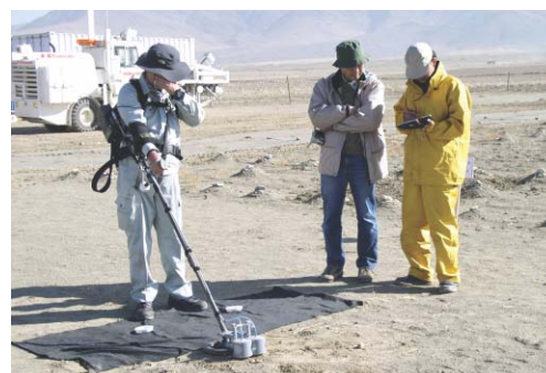
埋設したモデル地雷をモニター中のハンドヘルド型探知機
