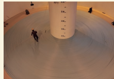
ケーブル敷設船の ケーブルタンク
