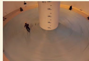
ケーブル敷設船の ケーブルタンク
