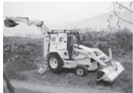
現地で稼働している地雷除去機。建設機械を応用しています
