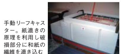
手動リーフキャストター。紙漉きの原理を利用し破損部分に和紙の繊維を漉き込む
