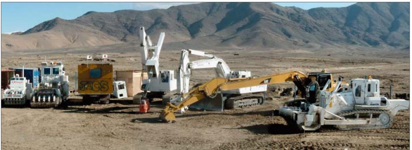
現地試験を行った地雷探知車両（左端）と地雷除去機（アフガニスタン）
