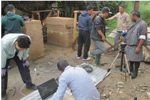
伝統工法サンプルの強度実験の様子
