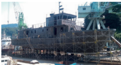
2021年6月、船台(せんだい)上で建造中のマーシャル↑ 向け医療船(提供：(一財)日本造船技術センター)
